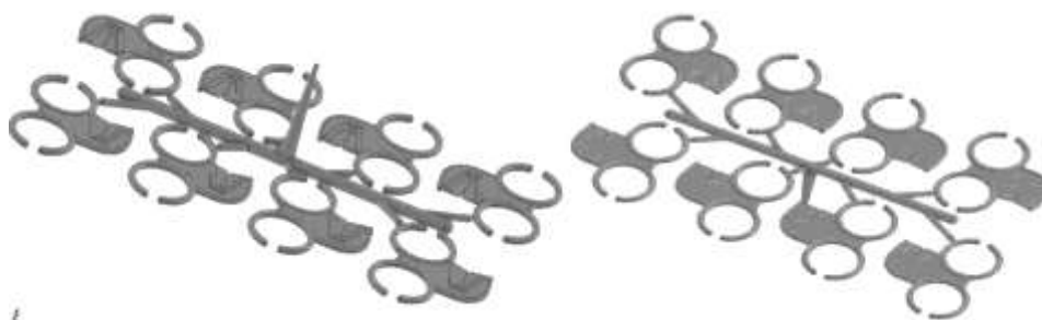
Figura 5- Vista 3D superior e vista inferior dos oito produtos injetados, juntamente ao galho de injeção
